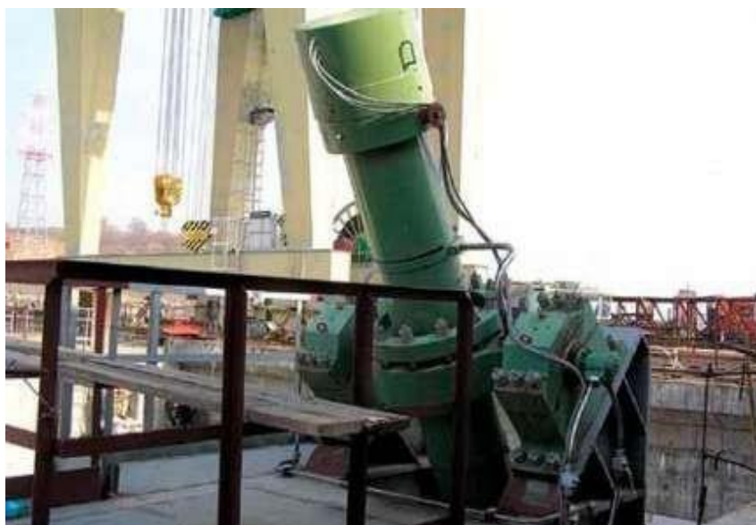
Сурет 2. Тұтқаны бар сегменттік құлыптау цилиндры.
