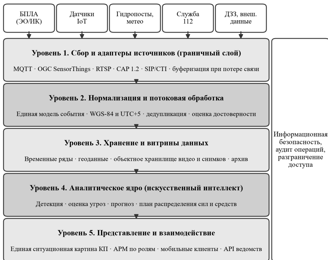
Рисунок 1 – Многоуровневая архитектура единой платформы ситуационного управления
