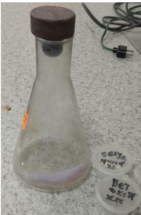
Рисунок 3 – Очищенный кристаллический бетулин после перекристаллизации
