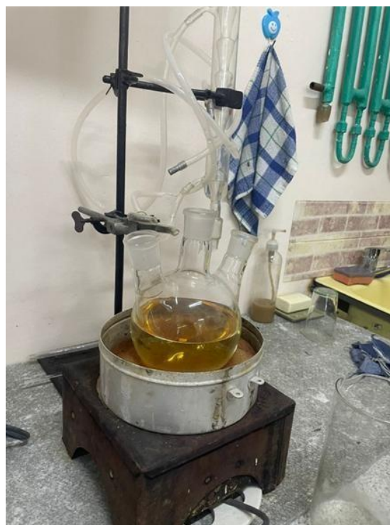
Рисунок 2 – Лабораторная установка для экстракции органическими растворителями
