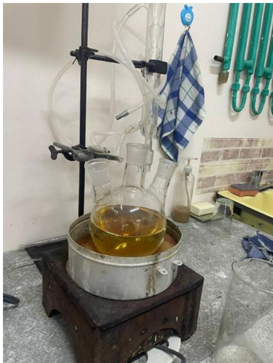
Рисунок 2 – Лабораторная установка для экстракции органическими растворителями
